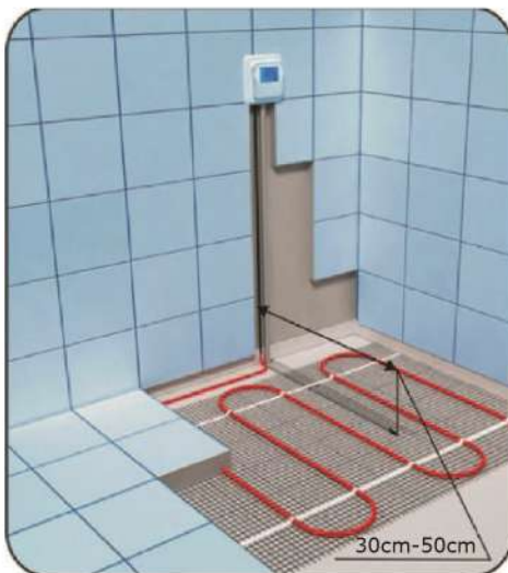
Montageschema für Temperaturmeßgeber im Wellenrohr
