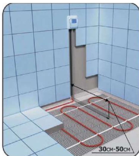
Схема укладки датчика температуры в гофрированной трубке
